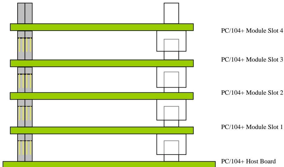
Figure 1 PC/104-*plus* module stack
