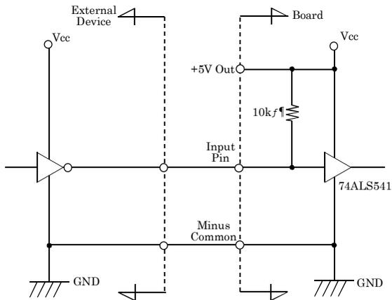
**Figure 3.5. Input Circuit**
