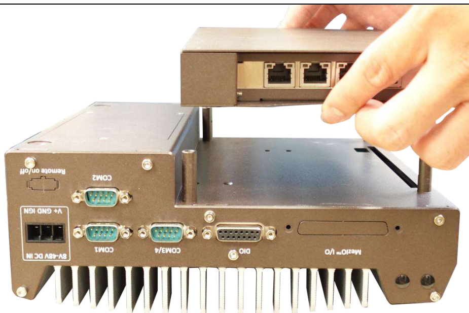
Install the Cassette module
